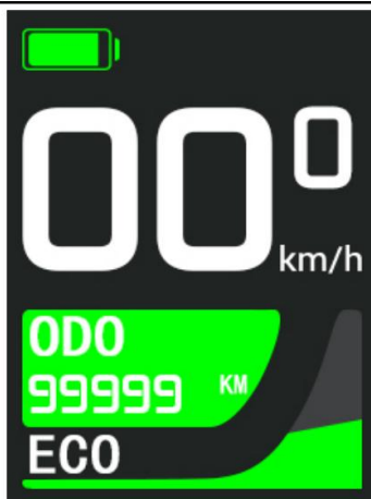
Realtime snelheids- en kilometer tellerweergave
