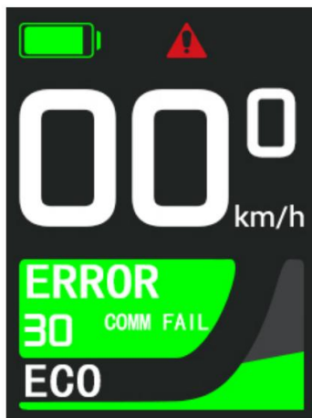
Interface voor weergave van foutcodes
